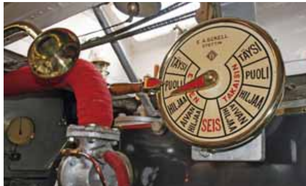
Konemestarin tärkeät "apulaiset", vakuuimittari, telegrammi sekä sen varalaitte "ruuppatorvi" (telegrammista vasemmalla). (Lauri Pakkanen, Ari Juva)
