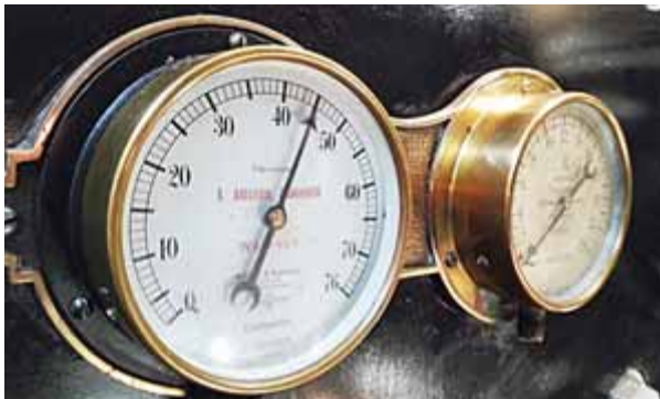
Konemestarin tärkeät "apulaiset", vakuuimittari, telegrammi sekä sen varalaitte "ruuppatorvi" (telegrammista vasemmalla). (Lauri Pakkanen, Ari Juva)
